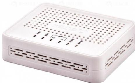
Рисунок 2.6 – Общий вид абонентского шлюза со встроенным роутером
